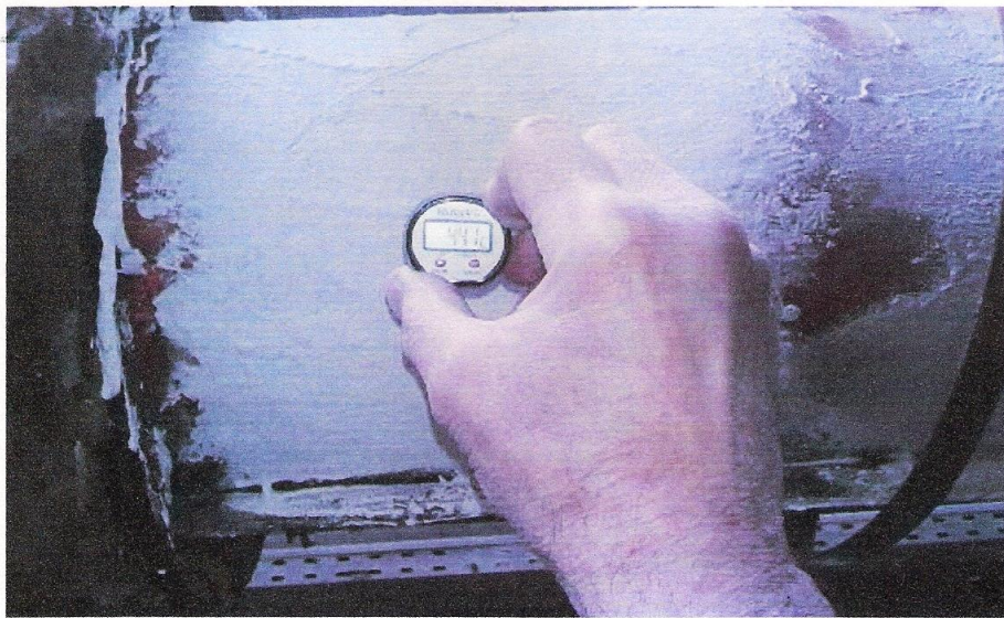
1,5 mm vastag TSM Kerámia hőszigetelés mérése
